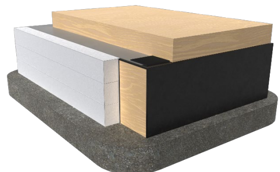
PRINCIPDETALJ INFÄSTNING MELLAN KL-TRÄ/SYLL OCH WOPAS GRUNDBALK - EJ SKALENLIG
