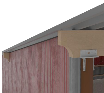
Bild 7. Träbalk med beklädnad av trä på ovasida och balkände.
