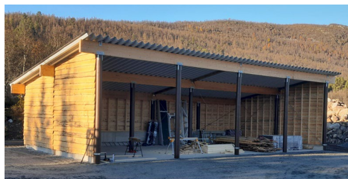
Pulpettak, 3 stolprader, snözon 6,5 kN/m 2 , redskapslager, Skurdalen, Norge
