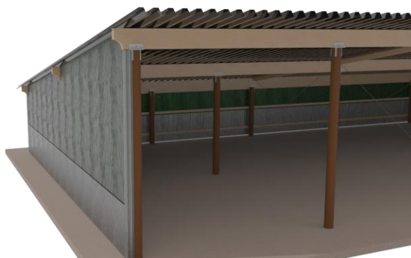
Principbild med väggplåt och detalj av hörnplåt vid främre stolpe.
